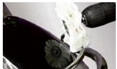
Wir empfehlen die Kombination von Poliertüchern verschiedener Tuchqualitäten und Polierpasten. Bitte beachten Sie, dass Polieren stets mit Paste durchgeführt werden sollte.
