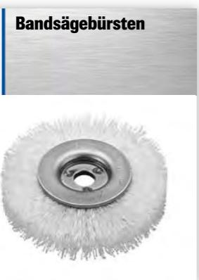
Zum Abbürsten von Spänen an Bandsäge- u. Kreissägeblättern zum Schutz der Sägeblattzähne. Erhöht die Standzeit des Sägeblattes u. optimiert die Schnittgenauigkeit. Drahtbesatz für Aluminium u. Metallanhäfungen, Nylonbesatz für Kunststoffe u. Holz.
