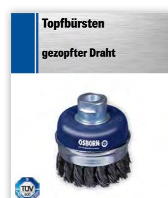
Leistungsstarke Topfbürsten für die Flächenbearbeitung. Hohe Reinigungswirkung aufgrund gezopfter Drahtausführung. Durch abnehmbaren Stützring kein seitliches Ausweichen des Besatzes. Nach Abarbeitung des freien Besatzes entfernen des Stützringes zur weiteren Nutzung.
