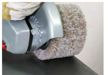
Satinieren verläuft in der Regel als einstufiger Prozess. Für das Satinieren benötigen Sie keine Pasten, da im Trägermaterial der Satinierwerkzeuge das Schleifkorn bereits enthalten ist.
